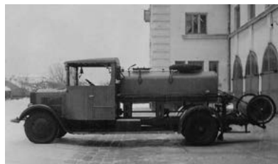
Samochód Miejskiej (a więc zawodowej) Straży Pożarnej w Stanisławowie z 1937 r., z zakrytą kabiną załogi, zbiornikiem na wodę i autopompą (stan blach wskazuje na samodzielne wykonanie zabudowy) Źródło: Centralne Muzeum Pożarnictwa w Mysłowicach.
