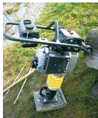
der Vibrationsstamper umg der Hopper vibratory tamper ubijak wibracyjny m вибрационная трамбовка f , виб्रोштамп m
