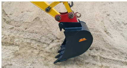
der Tieföffel backactor łyżka podsiębierna f ковш обратной лопаты m
