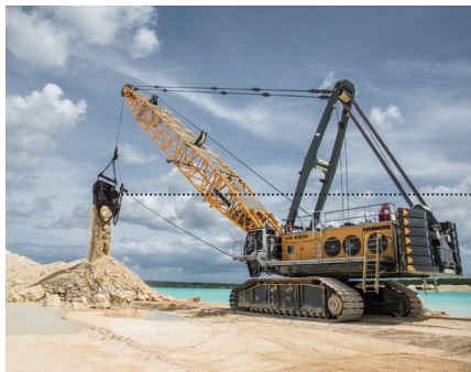
der Schleppkübel drag(line) bucket zgarniak m ковш драглайна m
